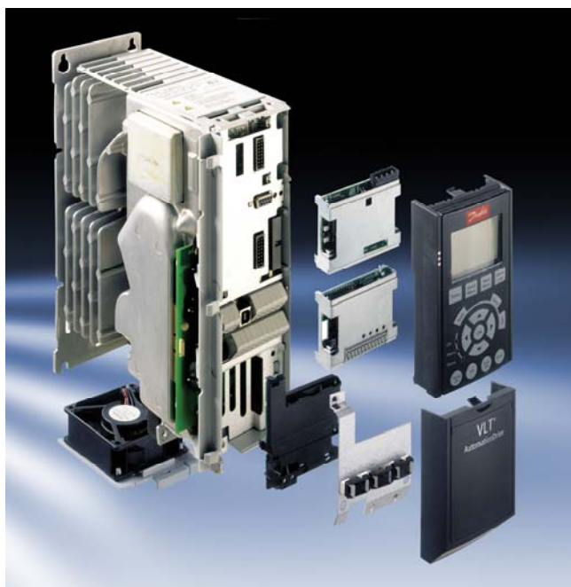
Bild 1: Danfoss LD 302 Control: Trotz kompakter Abmessungen beherbergt der Umrichter die komplette Steuerung sowie Zwischenkreisdrossel und EMV-Filter
